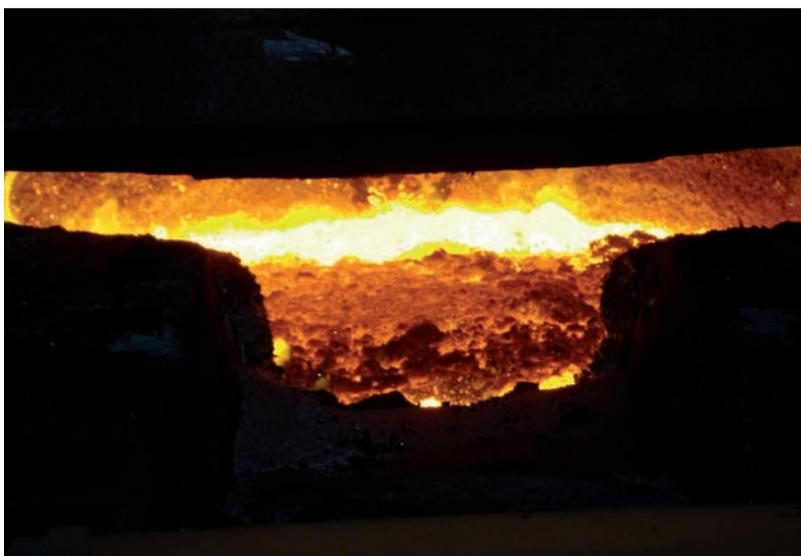
Fig. 11 La scoria alto fondente in forno dopo aggiunta dello 0,5% di sabbia silicea
