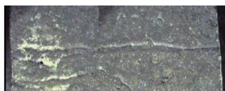
**Fig. 6 (a) Strato superficiale ossidato in un getto in gs, (b) presenza di falsi giunti freddi.**
