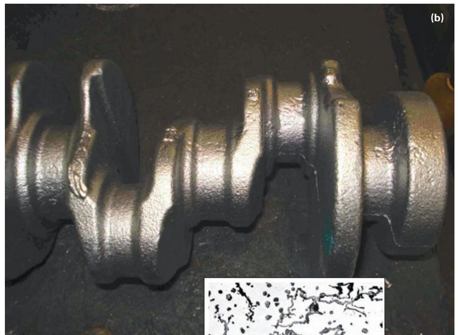
Fig. 3 (a) Aspetto tipico del Dross associato alla fusione elettrica (b) Imperfezioni superficiali nella direzione del flusso per eccesso di velocità di ingresso in un albero motore in gs.
