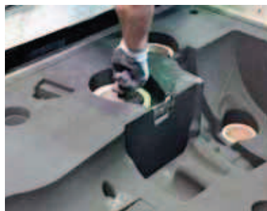
■ Fig. 12 - Il posizionamento di NETFrame® dopo formatura.
