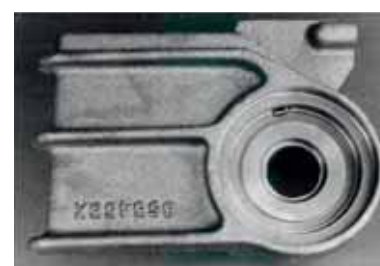
■ Fig. 12 - Cavità di ritiro comparsa dietro impiego di una certa partita di ghisa d'affinazione.
