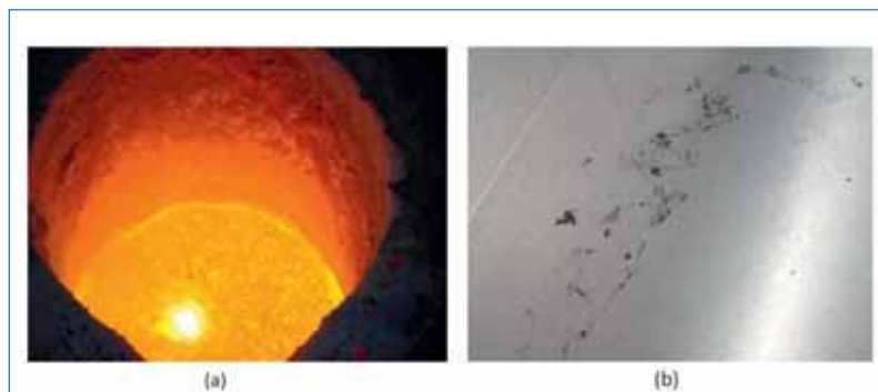
■ Fig. 9 - (a) Scoria fluida dopo trattamento al Mg (b) macrografia del dross dopo lavorazione.
