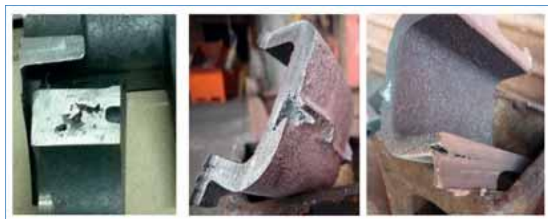
■ Fig. 5 - Risucchi associati alla presenza di austenite primaria.
